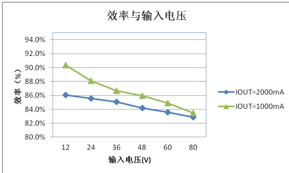
效率与输入电压及输出电流特性曲线 (V<sub>O</sub>=5V)
