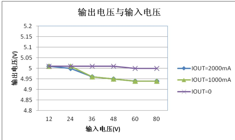
输出电压与输入电压及输出电流特性曲线 (V<sub>O</sub>=5V)
