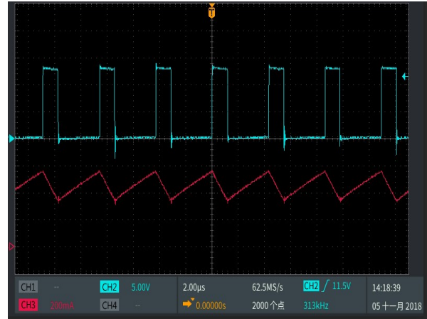
SW 脚与电感电流工作波形
